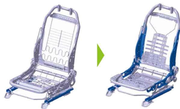
フレームにおける高張力鋼板採用部品(青色部分)の変遷
